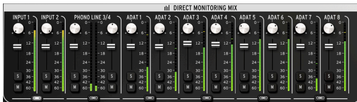
La partie Direct Monitoring Mix : vue ADAT à 8 canaux
