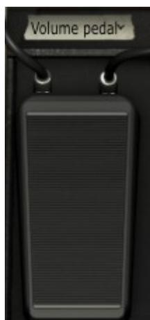
これはMIDI CC#7にアサインされるボリュームペダルとして動作します。ペダルをクリック、ドラッグをしてボリュームを変更することができます。
