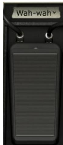
これはスタンダードなワウペダルとして動作します。デフォルトでは MIDI CC #11 エクスプレッションに割り当てられています。ペダルをクリック、ドラッグをしてワウの周波数を変更することができます。
