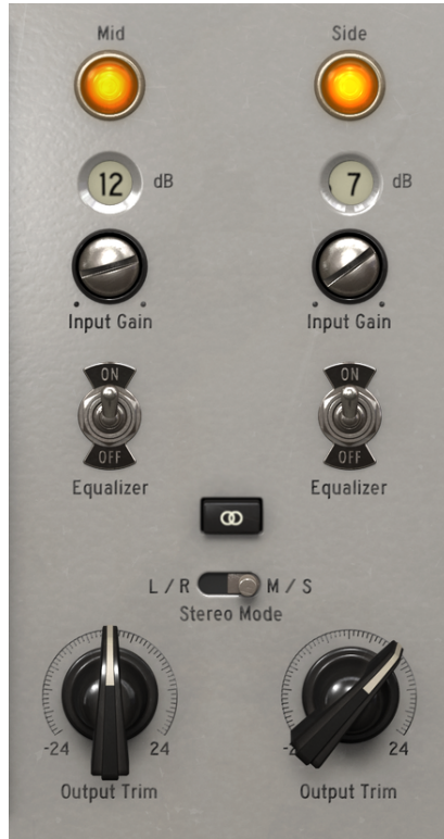
V76-Preダブルチャンネルのプリアンプと出力。ステレオリンクとステレオモードのスイッチは、出力トリムコントロールのすぐ上にあります。
