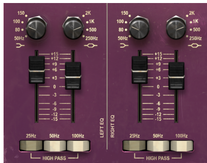
Les bandes inférieures de la config. Double Channel de l'égaliseur du TridA (Low Shelf et Low Midrange Bell), et les trois interrupteurs de Filtre passe-haut en bas
