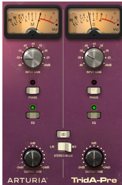
La partie préampli de TridA configurée pour fonctionner en mode M/S. L'interrupteur Stereo Link est éteint et l'interrupteur Stereo Mode est en position M/S.
