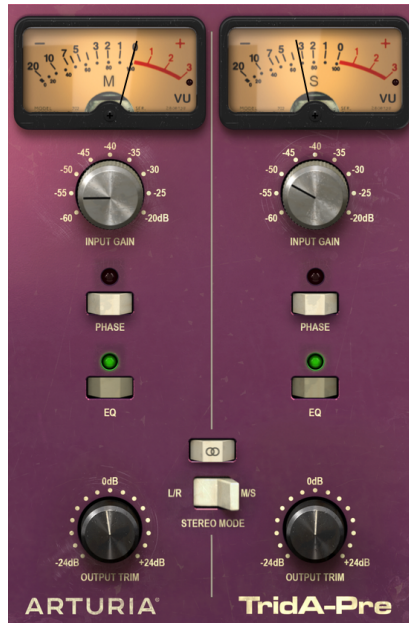
La sección de preamplificador TridA configurada para trabajar en modo M/S. Observa que el interruptor "Stereo Link" está desactivado y el interruptor de modo estéreo en la posición M/S.
