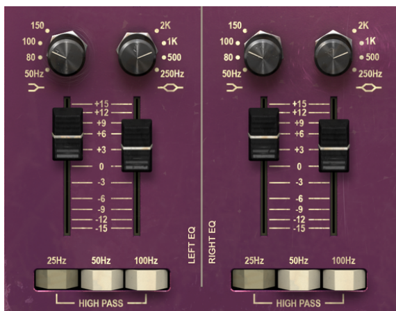
Las bandas inferiores del EQ de doble canal del TriDA (Low Shelf y Low Midrange Bell) y los tres interruptores del filtro pasa altos en la parte inferior.
