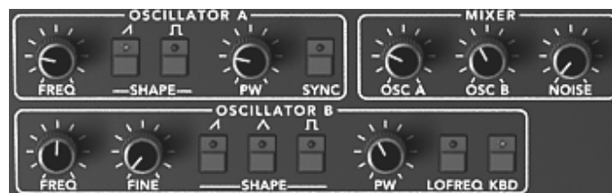
2 基のオシレーター
