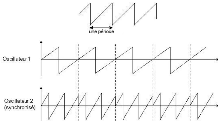
*L'oscillateur2 est synchronisé sur le premier puis accordé sur une fréquence de tonalité double.*
