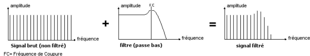
*Enlever les fréquences indésirables à partir de la fréquence de coupure*
