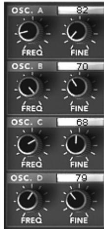
プロフェット VS モードのオシレーター・セクション
