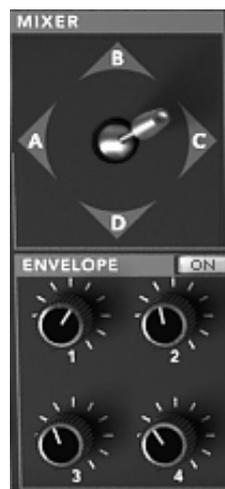
プロフェット VS モードのみキサー・モジュール (ミキサー・エンベロープ)
