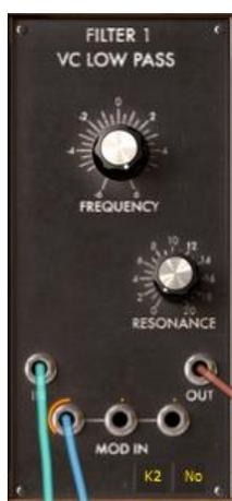
*モジュレーション入力のジャックを反時計回りに回す*
