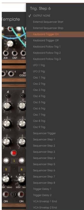
《トリガー出力》から《Keyboard trigger on》を選択する
