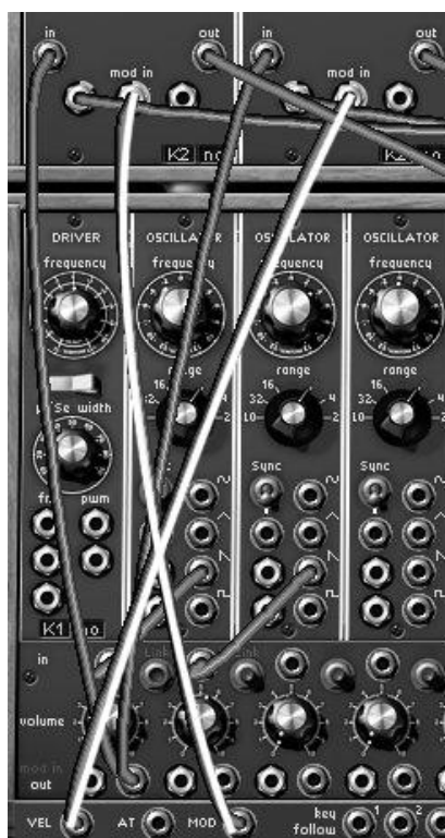
モジュレーション・ホイール出力をフィルター1、ベロシティ出力をフィルター2 に接続
