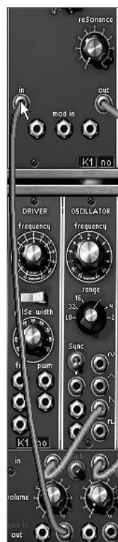
ミックスしたオーディオ出力をフィルター1へ接続する
