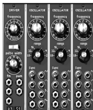
オシレーター・パート(《ドライバ・オシレーター》と 3 つの《スレーブ・オシレーター》)
