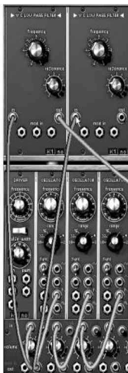
2 基目のフィルターとの接続
