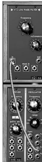
オシレーター1 とフィルター1 の接続
