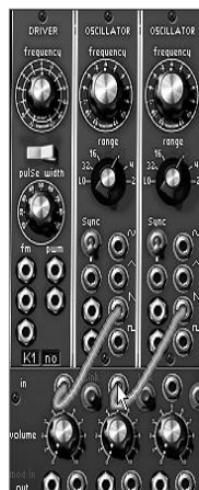
オシレーターとミキサーVCA の接続
