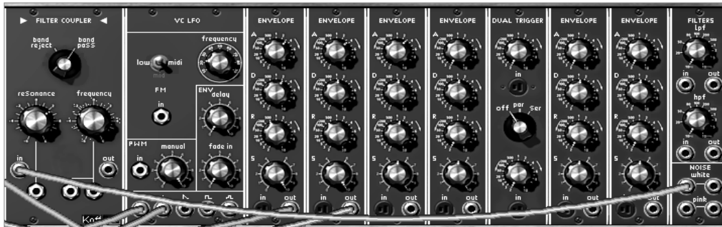
ホワイト・ノイズ・ジェネレーターからバンド・パス・フィルターへ接続
