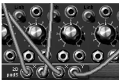
ジョイスティックの出力はコントローラー接続ジャックで接続する
