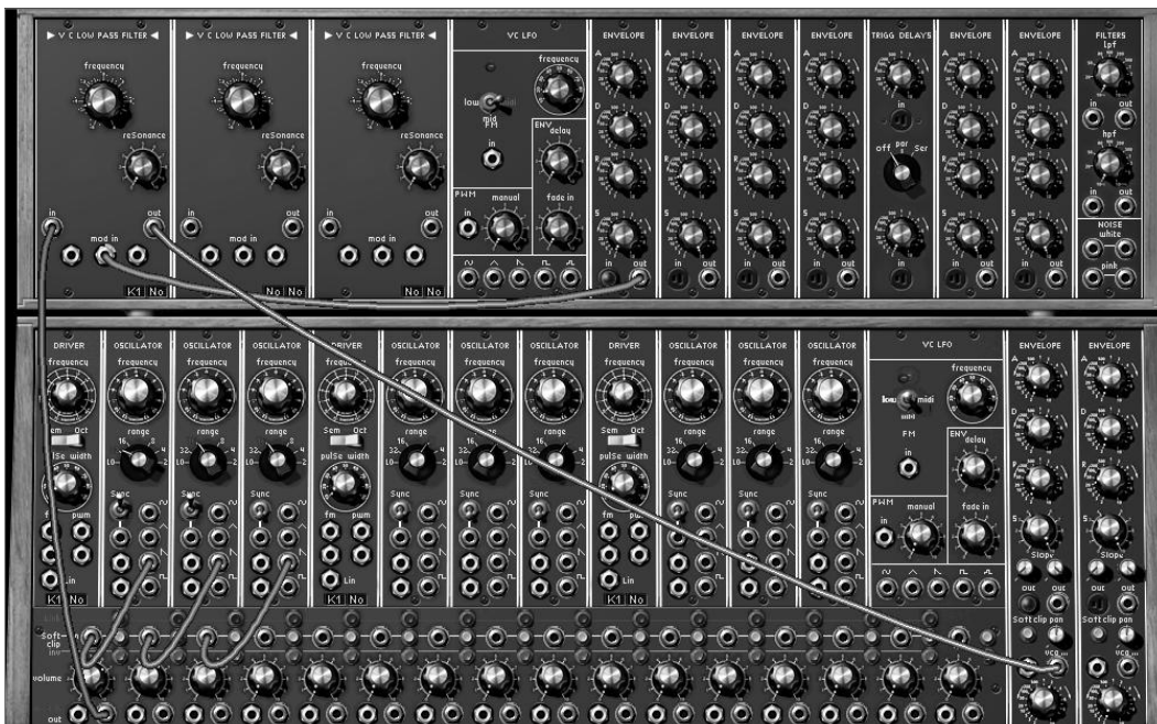
2つのキャビネット構成されるシンセシス・セクション
