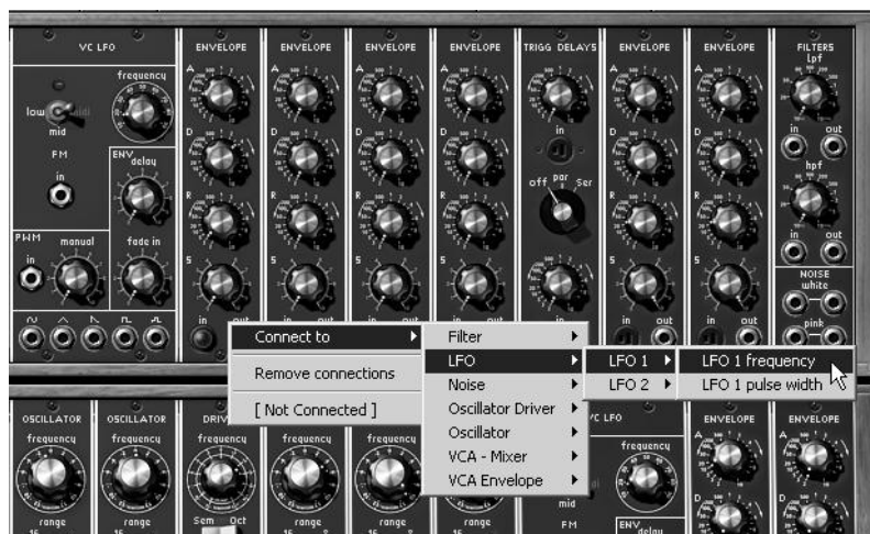
右クリック(または Shift+クリック)で入力(in)、出力(out)の接続メニューが表示されます。
