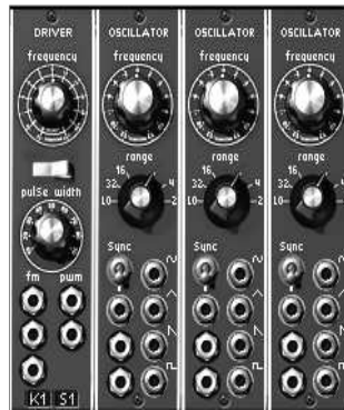
オシレーター・パート(《ドライバ・オシレーター》と3 つの《スレーブ・オシレーター》)
