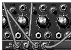
ジョイスティックの出力はコントローラー接続ジャックで接続する
