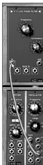
オシレーター1 とフィルター1 の接続
