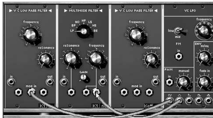
LFO1 から各フィルターへの接続
