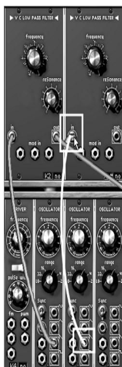
オシレーター2 とフィルター2 の接続
