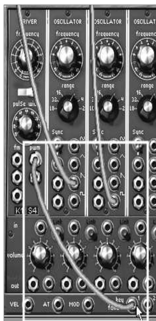
ドライバ・オシレーターを 1 列目のシーケンスに接続する
