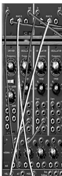
モジュレーション・ホイール出力をフィルター1、ベロシティー出力をフィルター2 に接続
