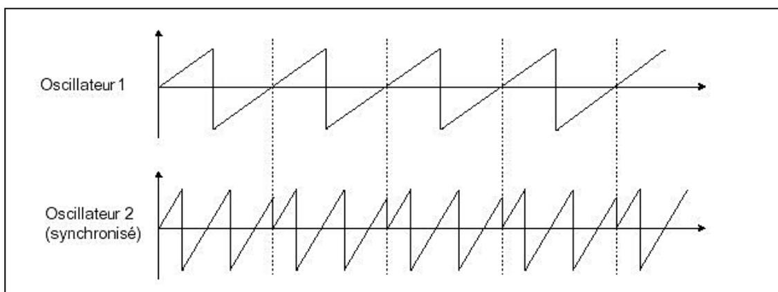
Sur l'image ci-dessus, l'oscillateur 2 est synchronisé sur le premier, puis accordé sur une fréquence de tonalité double.
