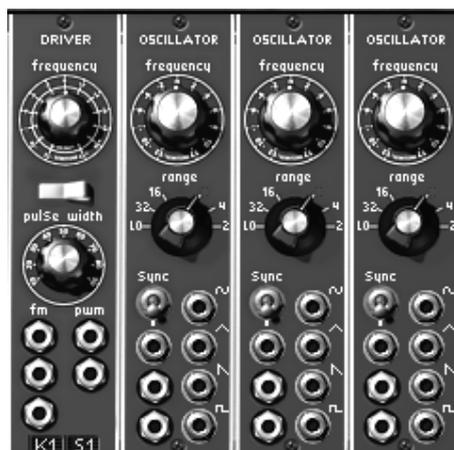
*Une banque d'oscillateurs : 1 « driver » et 3 « oscillateurs esclaves »*
