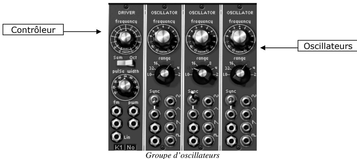
Le contrôleur permet de gérer la fréquence et la largeur d'impulsion des 3 oscillateurs esclaves, soit statiquement à l'aide des potentiomètres, soit grâce aux entrées de modulation qui peuvent être connectées à la sortie d'un module quelconque (enveloppe, oscillateur, molette de modulation...).
