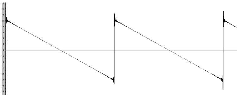
*Représentation temporelle de la forme d'onde « dent de scie » d'une reproduction logicielle du Moog 3c (réalisée par un concurrent)*
