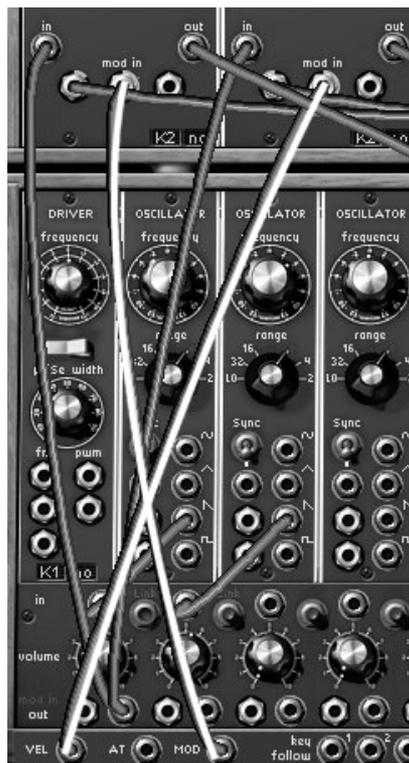
*Connexions des sorties de modulation et de vélocité sur la modulation de fréquence des filtres 1 et 2*
