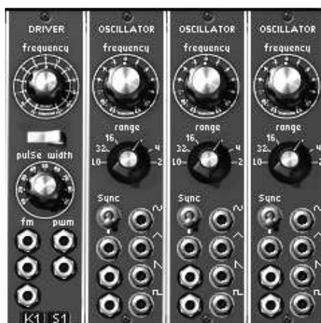
オシレーター・パート (《ドライバ・オシレーター》と3つの《スレーブ・オシレーター》)
