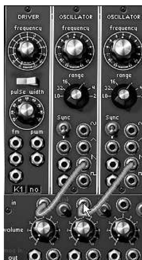
オシレーターとミキサーVCAの接続
