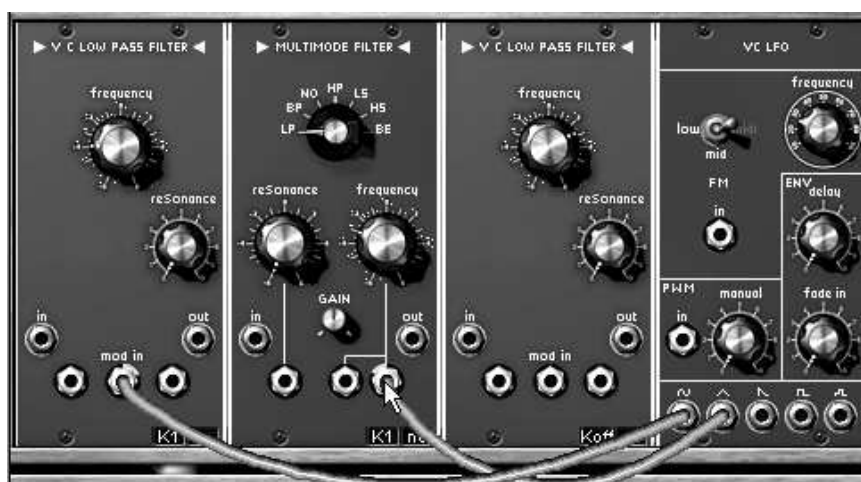
LFO1 から各フィルターへの接続
