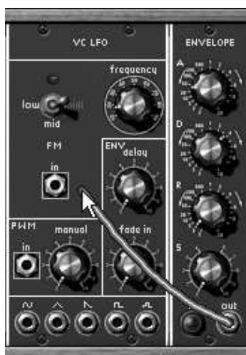
マウスによるケーブルの接続 (クリックしたままドラッグすることで可能)
