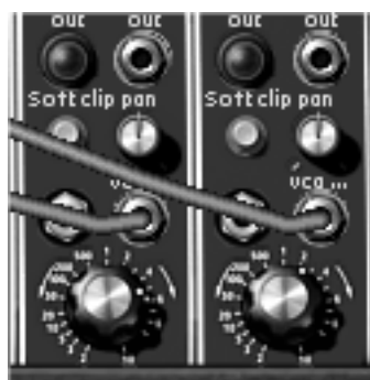
Le câblage vers les deux VCA
