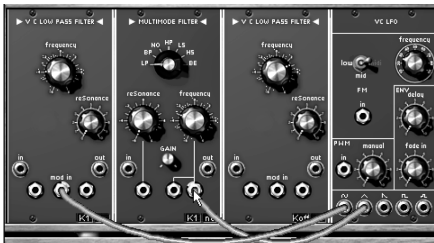
Liaison du LFO1 vers les filtres
