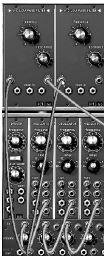
Câblage vers le 2e filtre
