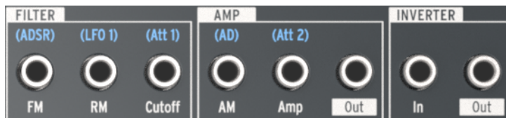
Las líneas blancas marcan los límites de la sección en la bahía de conexiones
