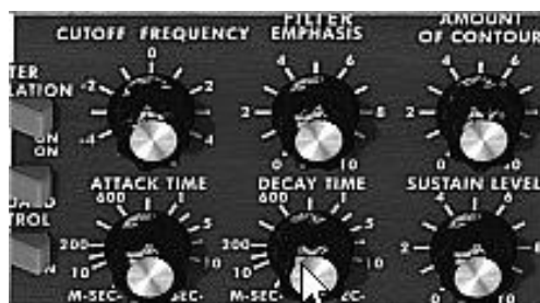
フィルターエンベロープのディケイタイムの値を増やす
