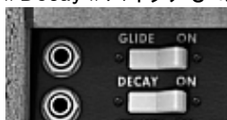
ペダルによるグライド(ポルタメント)とリリース・タイムのコントロール
