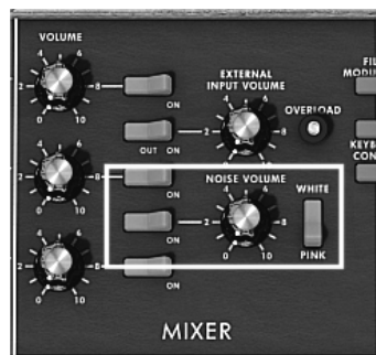
ノイズ・ジェネレーターをミキサー上で設定
