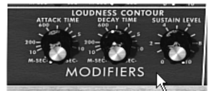
ラウドネス・コントゥアー部のアンプリチュード・エンベロープ
