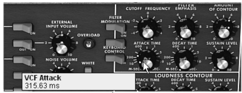
フィルター・エンベロープの《Attack time》パラメーター
