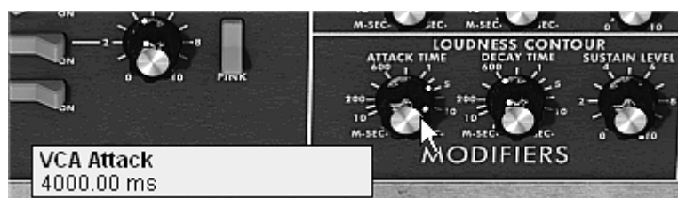
VCAエンベロープのアタック・タイムの変更
