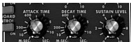
Paramètres du générateur d'enveloppe associé au filtre
