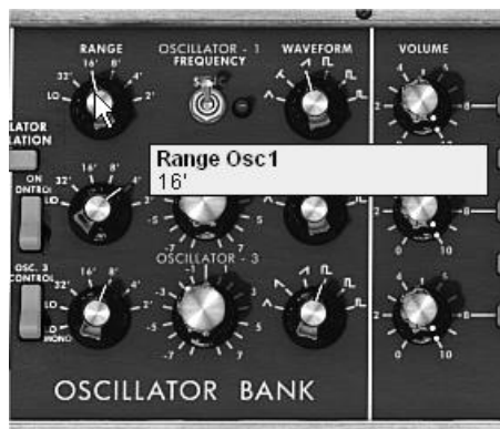
Réglage de la tessiture de l'oscillateur 1 (« Range »)
