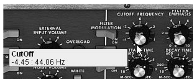
Baissez la fréquence de coupure du filtre
