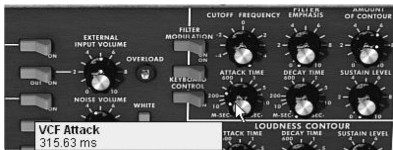
Le paramètre « Attack Time » de l'enveloppe du filtre
