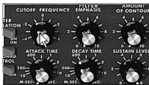
Baisser la fréquence de coupure du filtre passe bas
