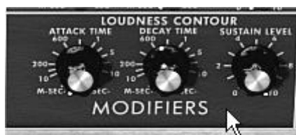
Les paramètres de l'enveloppe d'amplitude « Loudness Contour »
