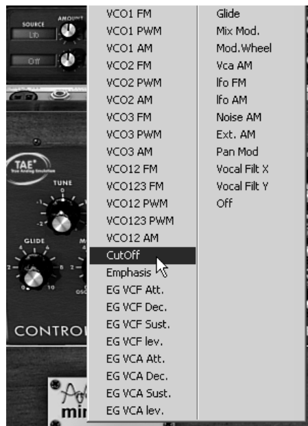
Moduler la fréquence du filtre (« Cutoff Frequency ») par le LFO
