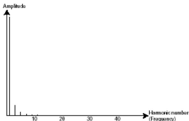
PWM 波 (パルス・ウィズ・モジュレーション) は矩形波の振幅周期が変調された波形です。これは「PWM」、またはモジュレーション (エンベロープまたは LFO) により手動で変調を行うことができ
