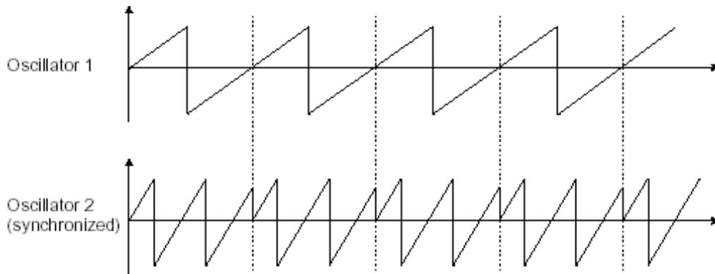
上の図はオシレーター2がオシレーター1によって強制的にシンクロをかけられ、二倍の振幅にチューニングされたものです。これによってレイヤーやフィルター効果のような通常のシンセシス・テクニックでは作り出せないユニークな波形を作ることができます。
