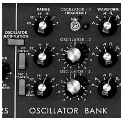
これらのオシレーターは異なるシンセ波形を右のつまみで切り替えて作り出します。オシレーター 1 と 2 は左から三角波、三角ノコギリ波、ノコギリ波 (SAW UP)、矩形波 1、矩形波 2 (パルス幅 25%)、矩形波 3 (パルス幅 10%) となっています。オシレーター 3 は三角ノコギリ波の代わりに SAW DOWN になっています。いずれのセレクターも右クリックで波形の中で三角波、三角ノコギリ波、矩形波 1、矩形波 2 (パルス幅 25%)、矩形波 3 (パルス幅 10%) はパルス幅を微調整できます。もし波形を再度変更した場合は初期値に戻ります。
