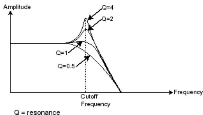
レゾナンス・レベルを上げていくとオシレーターは自己発振してサイン波を生成します。キー・フォローを利用してフィルターのカットオフ・フリクエンシーをコントロールすると、鍵盤でメロディーを作ることができます。
