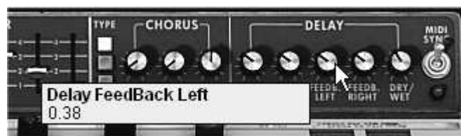
Le réglage du niveau de réinjection gauche « FeedB. Left »
