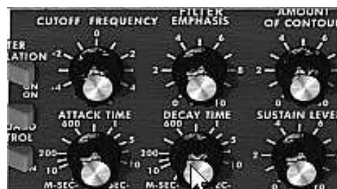
Augmentez le temps de décroissance de l'enveloppe du filtre
