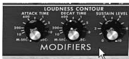
Les paramètres de l'enveloppe d'amplitude « Loudness Contour »
