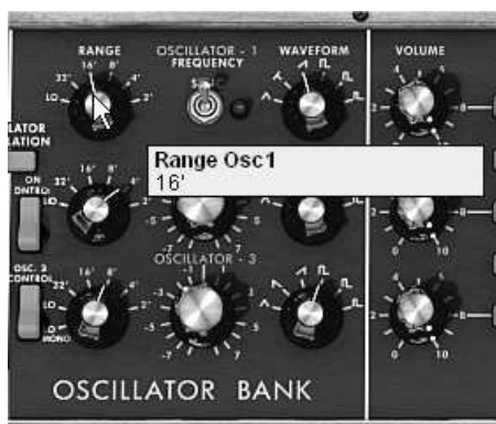
Réglage de la tessiture de l'oscillateur 1 (« Range »)
