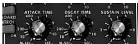
Paramètres du générateur d'enveloppe associé au filtre
