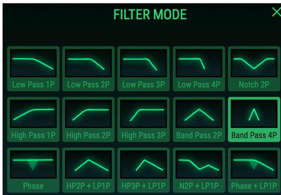
*Eines der M12-Filter-Modus-Auswahlfenster mit einem Bandpass 4P-Filtertyp*
