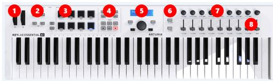
1. **Ruedas de Tono & Modulación** Éstos se utilizan para controlar los parámetros de tono y modulación tu sonido.
