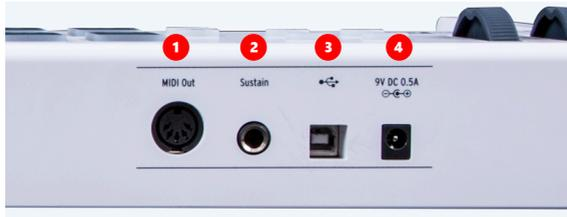
1. **Salida MIDI** El puerto de salida MIDI de KeyLab Essential se puede utilizar para enviar información MIDI a los sintetizadores externo y Cuando se alimenta con la fuente de alimentación opcional, en lugar de a través de USB.
