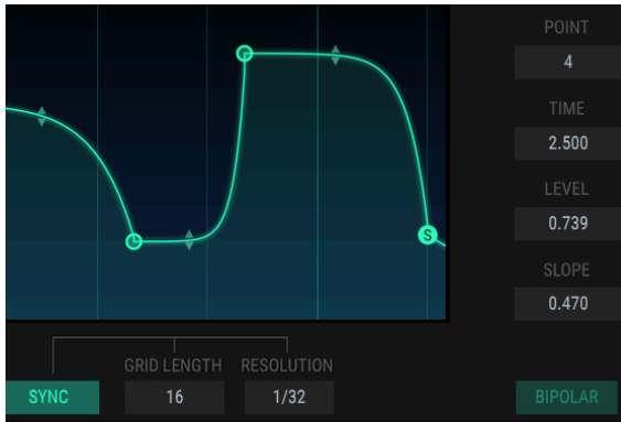
Eine unipolare Pitch-Hüllkurve
