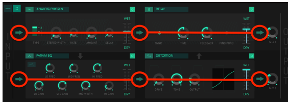
Signalfluss der Effekt-Kette im parallelen Modus
