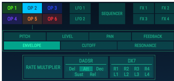
Auswahl der DADSR-Hüllkurven-Attack für Operator 2 als Modulations-Ziel
