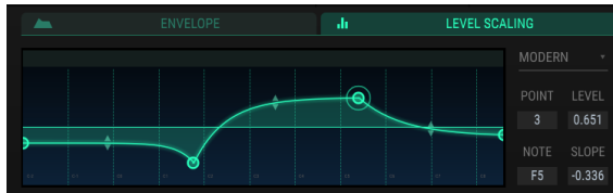
Beispiel für eine Modern Level Scaling-Kurve
