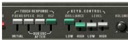
Réglage de la modulation par la pression
