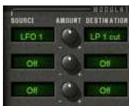
Moduler la fréquence du filtre passe-bas (LP 1 cut) par le LFO (LFO 1)
