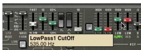
Réglage de la fréquence de coupure
