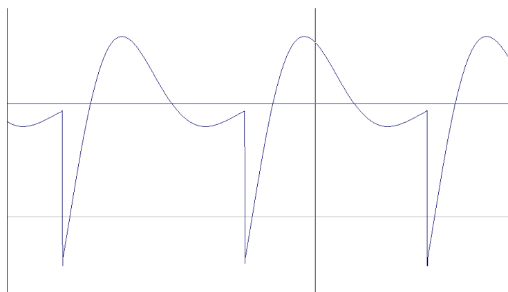
Représentation temporelle de la forme d'onde «dent de scie» (déformée par le filtrage passe-haut et passe-bas) du CS-80
