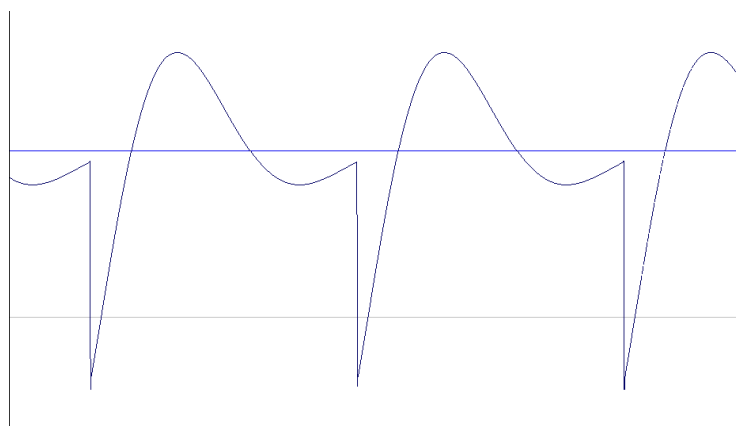
Représentation temporelle de la forme d'onde «dent de scie» (déformée par le filtrage passe-haut et passe-bas) reproduite par TAE
