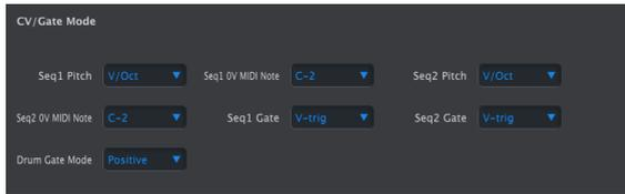
Aquí es donde se selecciona el comportamiento eléctrico para cada secuenciador. Los diversos ajustes se describen en el capítulo [Funciones CV/Gate \[p.81\]](#): consulta las [Especificaciones de CV/Gate \[p.82\]](#) para SEQ1/SEQ2 y las [Especificaciones de Drum Gate \[p.84\]](#) para DRUM.
