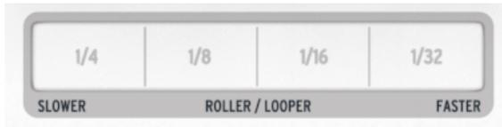
La tira táctil tiene dos modos: **Roller** y **Looper**. Puedes alternar rápidamente entre los dos modos manteniendo presionado el botón Shift y pulsando el botón del paso 9 mientras se está en modo de control.
