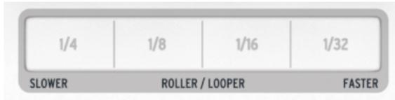
La tira táctil tiene dos modos: "Roller" y "Looper". Puedes alternar rápidamente entre los dos modos manteniendo presionado el botón Shift y presionando el botón de paso 9 mientras estás en el modo Control.
