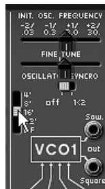
Réglage de la tessiture de l'oscillateur 1 (« Range »)
