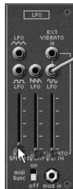
Réglez la vitesse d’oscillation du LFO
