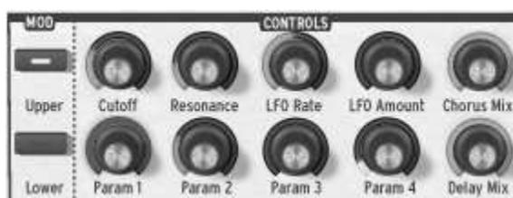
Les boutons MOD à gauche, la section Controls à droite
