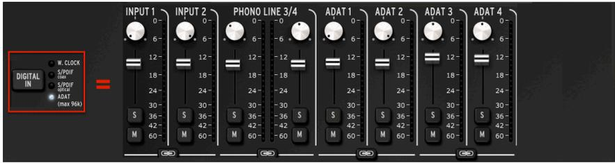
ADATの最大サンプルレートは88200と96000です。これらのレートでは、ADATデバイスからAudioFuseに4チャンネルのオーディオしか送られないため、ダイレクトモニタリングミックス・ウィンドウには、4チャンネルしか表示されません。
