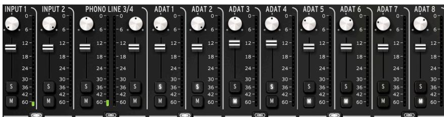
デジタル入力が、ADATに設定され、2種類の最低サンプリングレートの内の1つが選択されると、8つのADATチャンネルが表示されます。
